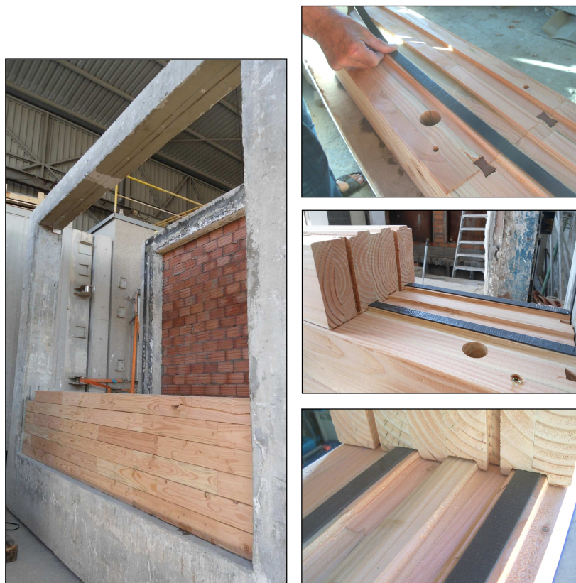
Imágenes 6 a 9 Construcción del cerramiento de ECO LADRILLO MASENA en el marco portamuestras, con detalle de las juntas de espuma en la union horizontal entre hiladas de ECO LADRILLO MASENA
