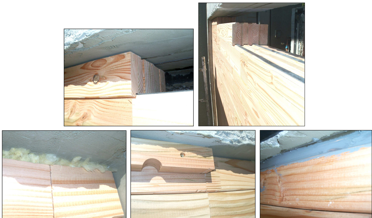
Imágenes 12 a 16 Holgura entre última hilada y marco portamuestras y su sellado
